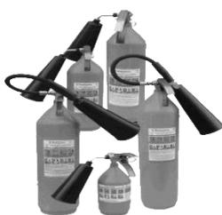
Предназначены для того, чтобы потушить горение различных веществ, но только таких, горение которых не может происходить без доступа воздуха: горючих жидкостей, газов, а так же электрооборудования находящегося под напряжением не более 1000В. Огнетушители углекислотные не предназначены для тушения загорания веществ, горение которых может происходить без доступа воздуха (алюминий, магний и их сплавы, натрий, калий)
