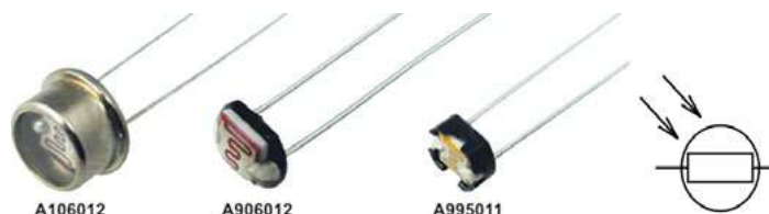
Рис. 12. Фоторезисторы и их обозначение
